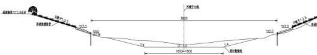
图 2-14 桩号 8+250~9+250 段河道设计断面
