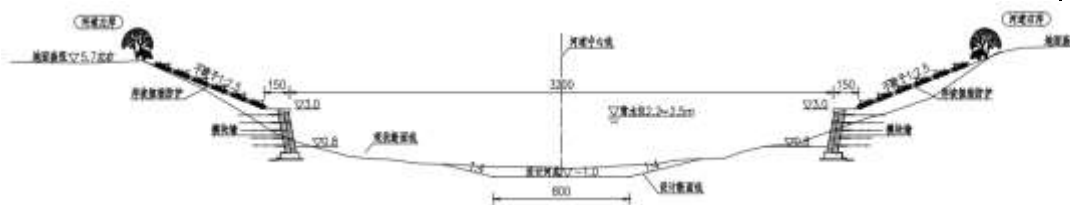
图 2-7 桩号 4+450~5+000 段河道设计断面
