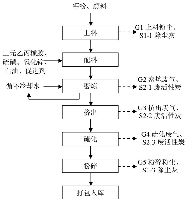
图 2-1 本项目生产工艺流程及产污环节图
