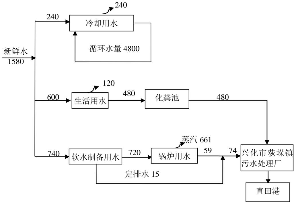
图 2-1 本项目水平衡图 单位: t/a
