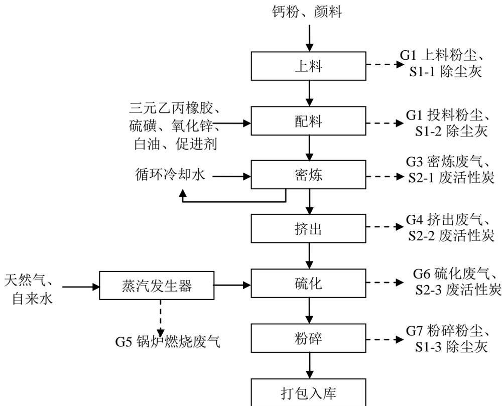
图 2-1 本项目生产工艺流程及产污环节图
