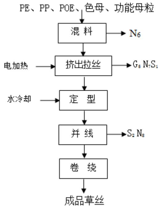
图 2-3 现有项目人造草丝生产流程及产污环节图
