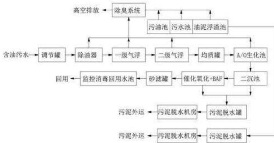
图 4-3 含油废水处理装置处理工艺流程图
