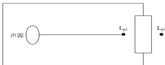
图 6.4.2-1 室内声源等效为室外声源图例
