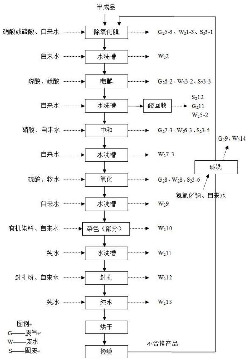
图 3.3-3 氧化车间电解工艺流程图
