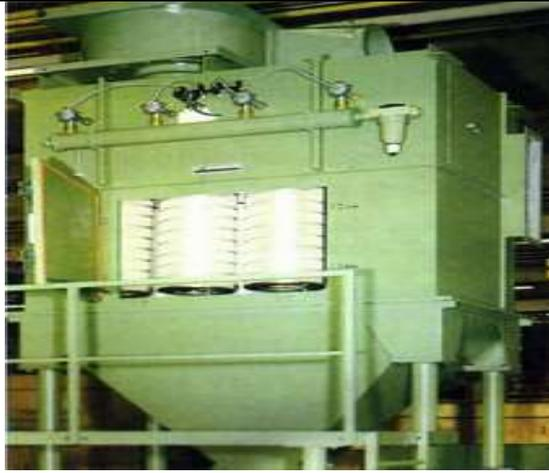
图 5-5 脉冲式滤筒除尘系统示意图
