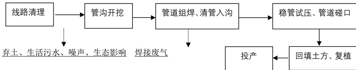
图 4-2 管道敷设流程示意图
