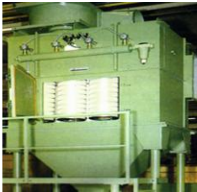
图 5-2 脉冲式滤筒除尘系统示意图
