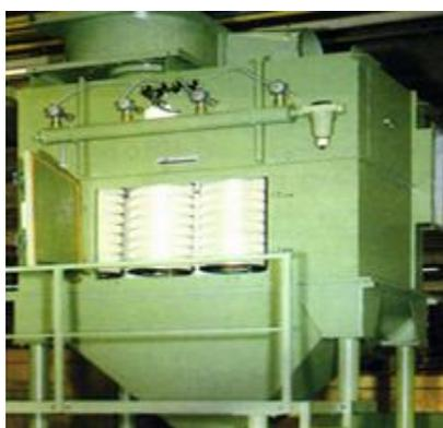
图 5-4 脉冲式滤筒除尘系统示意图
