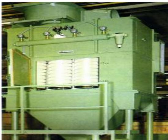
图 5-5 脉冲式滤筒除尘系统示意图
