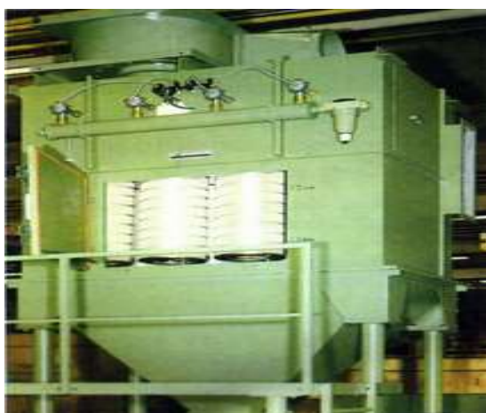
图 5-6 脉冲式滤筒除尘系统示意图
